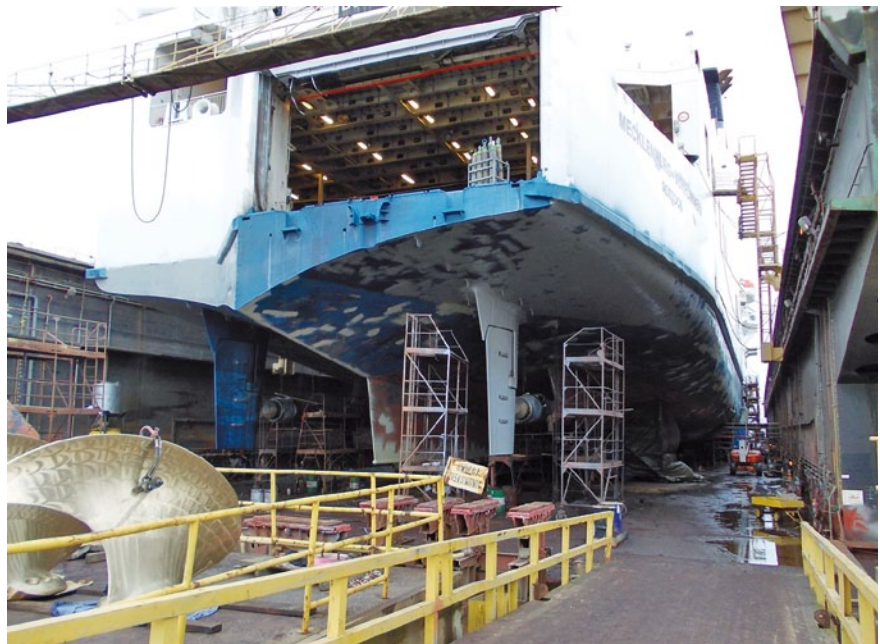
Hier wurden Ruder, Heck und Scheuerleiste neu beschichtet
