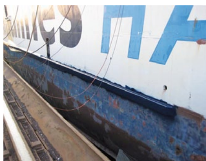
Hier wurden Ruder, Heck und Scheuerleiste neu beschichtet
