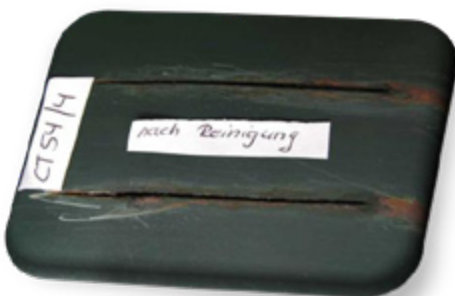
Gereinigte Testplatte nach 10.000 Std.
